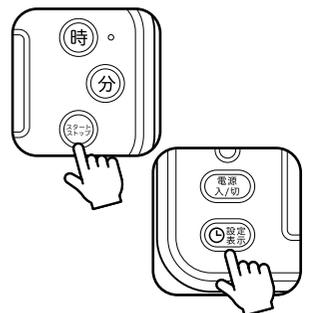
③「時設定ボタン」を押すと時刻が変わります。現在時刻を表示したら「分設定ボタン」を押します。
