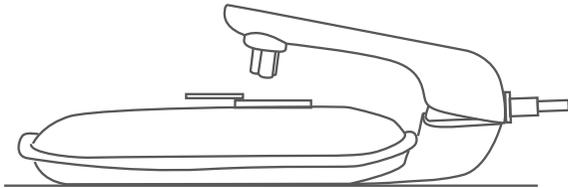
3. 蓄熱用電源ケーブルのアームを倒して、蓄熱プラグを蓄熱用コンセントの奥まで確実に差し込んでください。
